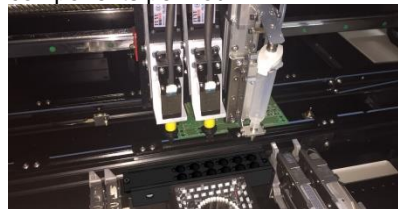
Inoplacer PRO 22D: Doppelbestückkopf, Dispenser und Werkzeugwechsler
