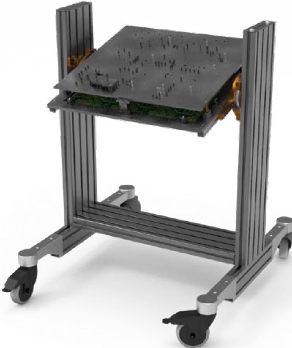
Ces outillages permettent le brasage manuel de composants simples ou complexes. Développés sur mesure, ils sont d'une véritable efficacité pour les opérateurs.
