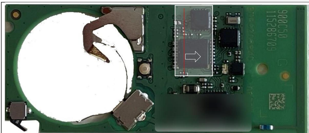
Position de l'échantillon prélevé et position de coupe + direction de la progression du polissage
