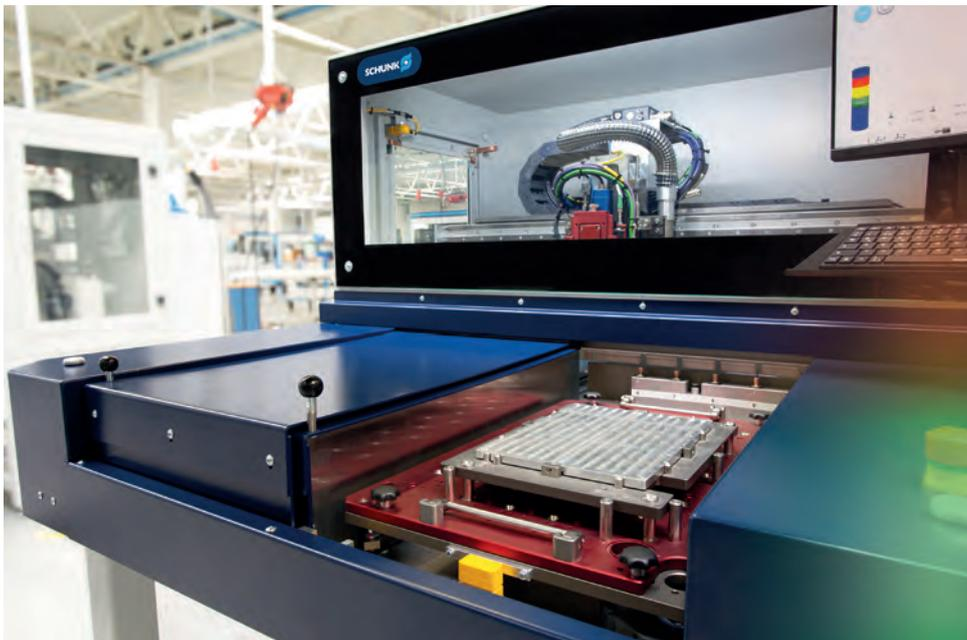
In der Basisversion ist der Nutzentrenner mit einem Shuttle konfiguriert. Die Maschine kann jedoch mit einem zweiten Shuttle ausgerüstet werden, um Totzeiten zu vermeiden und eine höchstmögliche Ausbringung zu erreichen.
