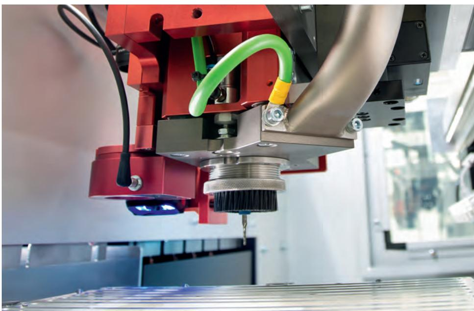
Die Grundausstattung besteht aus einem Frässpindelmodul. Optional kann der Fräskopf mit einem Visionsystem oder Scanner ausgerüstet werden.
